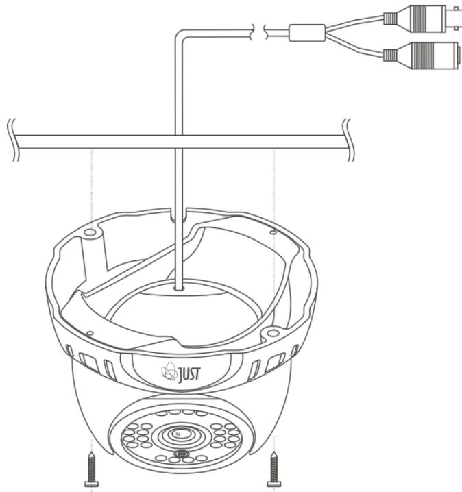
Приклейте монтажный шаблон в место, где планируется установка камеры. Основание купола крепится к поверхности четырьмя винтами #10, которые поставляются в комплекте, через четыре отверстия в основании купольной камеры. Затем прикрепите купол к основанию соответствующими винтами.
