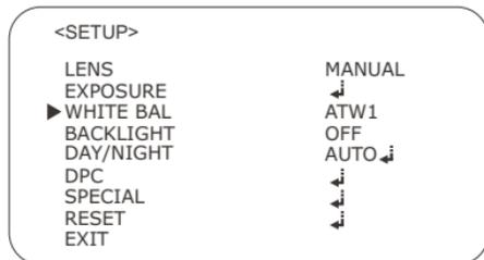
**ATW (автоматическое отслеживание баланса белого):** Этот режим может быть использован в пределах цветовой температуры 1800 ° K ~ 10,500 ° K (например, флуоресцентный свет, на улице, натриевая лампа и т.д.)
