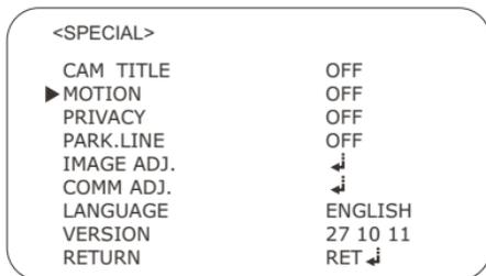
Данная видекамера имеет функцию, которая позволяет следить за движением объектов в выбранной области на экране.
